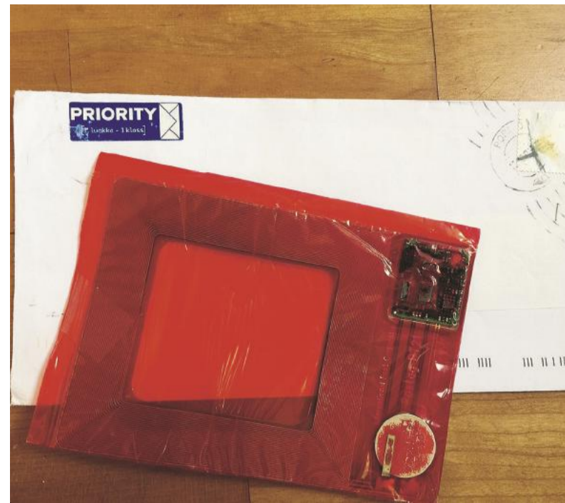
IL TRANSPONDER È un apparato elettronico inserito nella lettera, inviata in Italia dall'estero, da chi sta controllando la qualità. I rilevatori posizionati all'ingresso dei centri di smistamento di Poste, tramite l'impulso radio trasmesso, certificano data e ora d'ingresso. Sopra, un transponder inviato dalla Finlandia: trattenuto, sostiene la nostra fonte, per evitare che un ritardo di consegna venisse registrato, nel 2007
